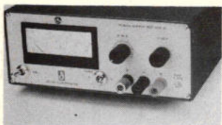
G 7. Gestabiliseerde voeding.
